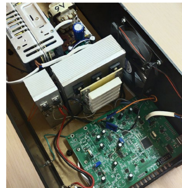
Устройство измерения тепловых характеристик активных элементов ЭМ и МС. Источник: Вячеслав Сергеев
